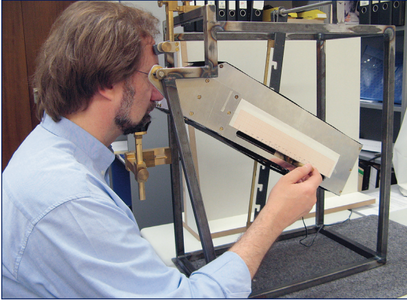
Abb. 7: Ansicht des Neigungsoptometers: ein Proband variiert den Sehabstand des Sehobjektes im Optometer, das auf eine Neigung von 30 Grad eingestellt ist.
